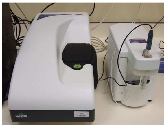
Figura 18. Zetasizer Nano ZS - ZEN3601. (Disponível em: < https://www.ices.a-star.edu.sg/media/1186/cps14.jpg > Acesso em 05 de abril de 2015)
