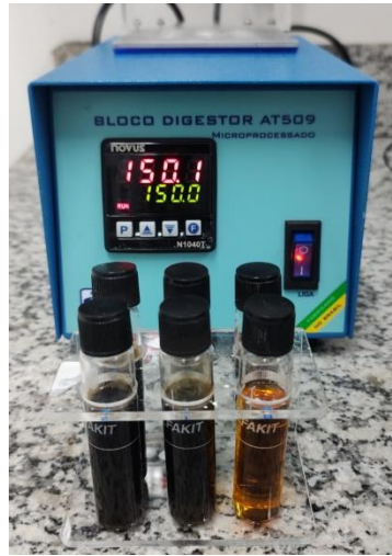
Figura 3 - Análise de demanda química de oxigênio (DQO) utilizado o kit da Alfakit ® , segundo instruções do fabricante com bloco digestor.
