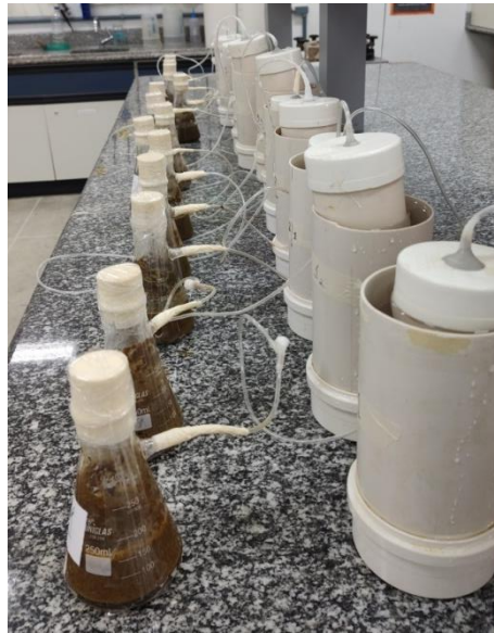
Figura 2 - Biodigestores de bancada confeccionados utilizando frascos kitassatos de 250 ml, ligados por meio de mangueiras de silicone aos seus respectivos gasômetros.
