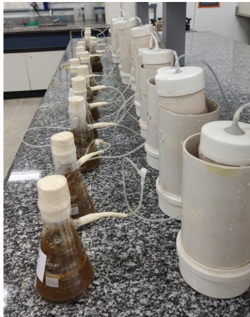
Figura 1- Biodigestores de bancada confeccionados utilizando frascos kitassatos de 250 mL, ligados por meio de mangueiras de silicone aos seus respectivos gasômetros.
