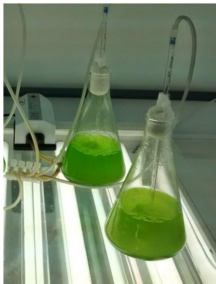
Figura 5. Frascos erlenmeyer com aeração utilizados para o cultivo de microalgas.
