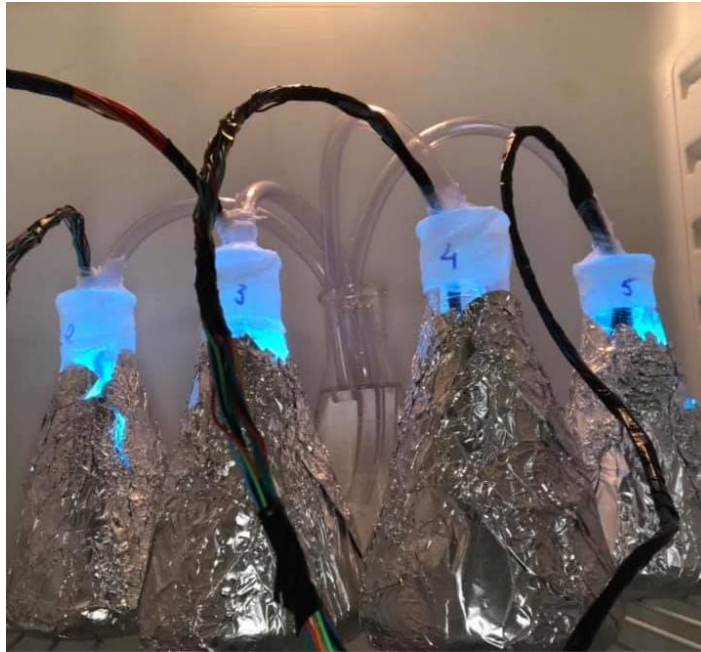
Figura 12: Irradiação das amostras com a luz LED azul (475nm) com potência de 4,5 W e irradiância de 112,5 \text{ mW/cm}^2
