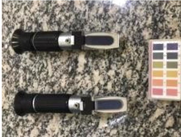
Figura 7: Refratômetro alcoômetro acima, Refratômetro medidor de Grau Brix abaixo e Fita de Ph ao lado.
