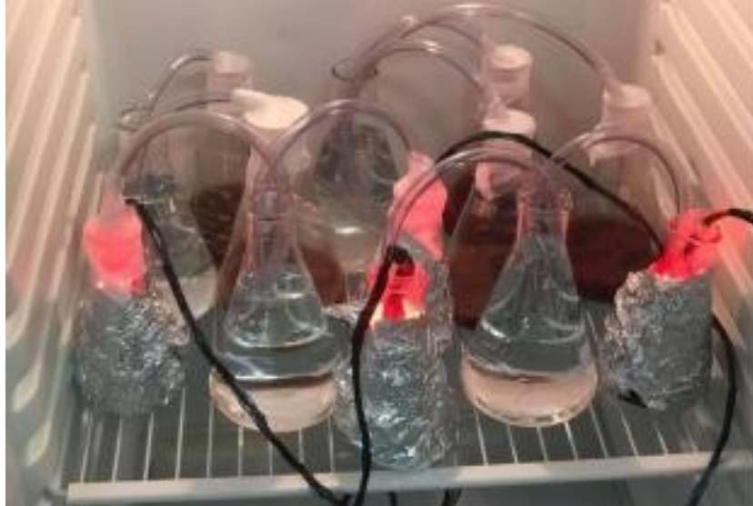
Figura 14: Irradiação das amostras com Luz LED vermelha (625 nm) com potência de 4,5 W, irradiância de 112,5 \text{ mW/cm}^2 e fluência de 486 \text{ J/cm}^2
